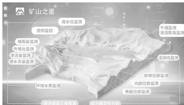
尾矿库在线监测系统
